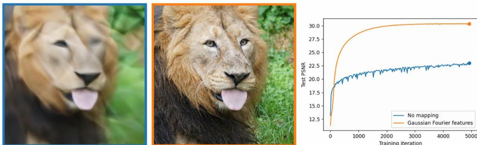
ABBILDUNG 5.4: Niederdimensionale Problemdomäne für jede Bildkoordinate  $(x,y)$  eine Ausgabefarbe  $(r,g,b)$ , kann durch ein MLP besser approximiert werden, wenn die Bildkoordinaten zuvor durch Feature Mapping in einen hochdimensionalen fourier Raum abgebildet werden.
