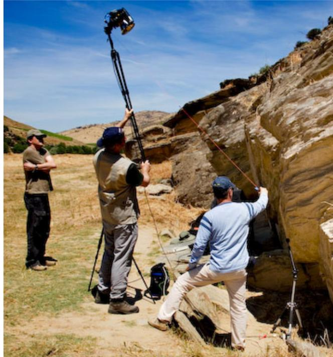
**Abbildung 3.6:** Aufnahme eines Highlight RTI. Die Kamera wird an einer festen Stelle aufgestellt und die unterschiedlichen Lichtrichtungen werden nach der Repositinierung der Lichtquelle aufgenommen. Ein Faden dient als Hilfe um gleichmäßigen Abstand zum Objekt bei jeder Aufnahme zu halten [24].
