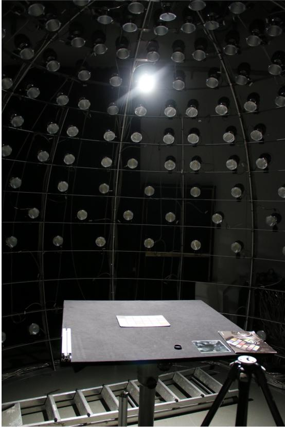
**Abbildung 3.3:** Teil der Light Stage an der Hochschule der Medien, mit 240 Lampen die an einer Stahlkuppel befestigt sind. Darunter ein Tisch zur Platzierung des aufzunehmenden Objekts. Mittig über dem Tisch ist im Zenit der Kuppel eine Kamera angebracht.
